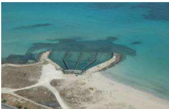
Figura 17 - Scarico acque di raffreddamento
