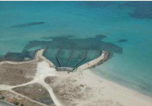
Figura 13 – Scarico acque di raffreddamento
