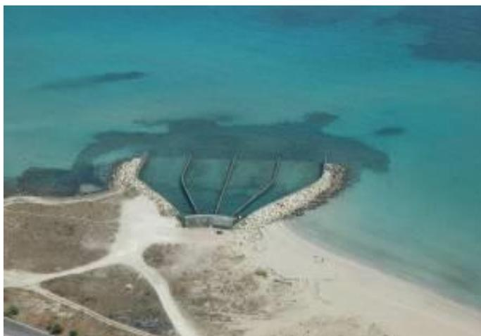
Le acque di mare di raffreddamento, con una portata complessiva per le due unità di circa 24 m<sup>3</sup>/s, attraversano un grandissimo numero di tubi di piccolo diametro, all'interno di apparecchiature denominate condensatori, assorbendo il calore residuo contenuto nel vapore che proviene dallo scarico della turbina.
