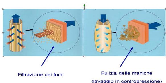
Figura n° 12 - Principio di funzionamento filtro a maniche
