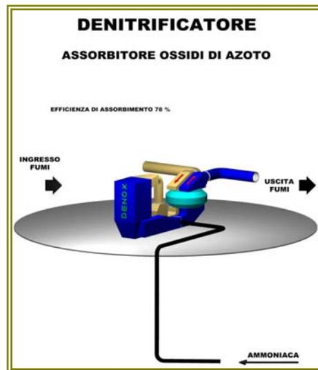
Figura n° 15 - Sistema di abbattimento ossidi di azoto
